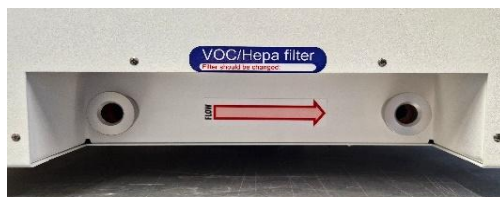
Figura 12.1 A seta do fluxo na incubadora de FIV multicâmara Mini MIRI® Dry
