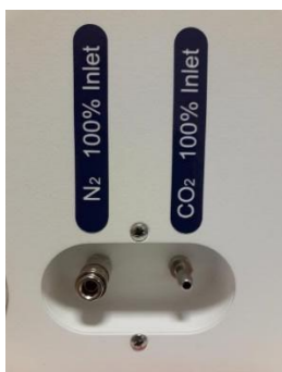
Figura 11.1 Entradas de gás na parte traseira das Incubadoras de FIV multicâmara Mini MIRI® Dry e Mini MIRI® Humidity
